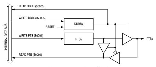
Figure 12-7. Port B I/O Circuit
